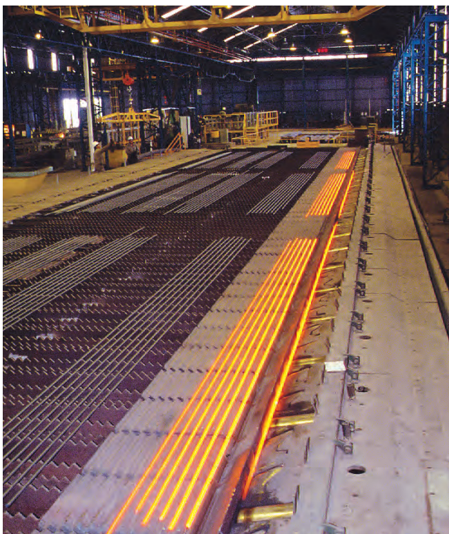
▼ Planta laminadora de varillas de bombeo. San Luis, Argentina.
